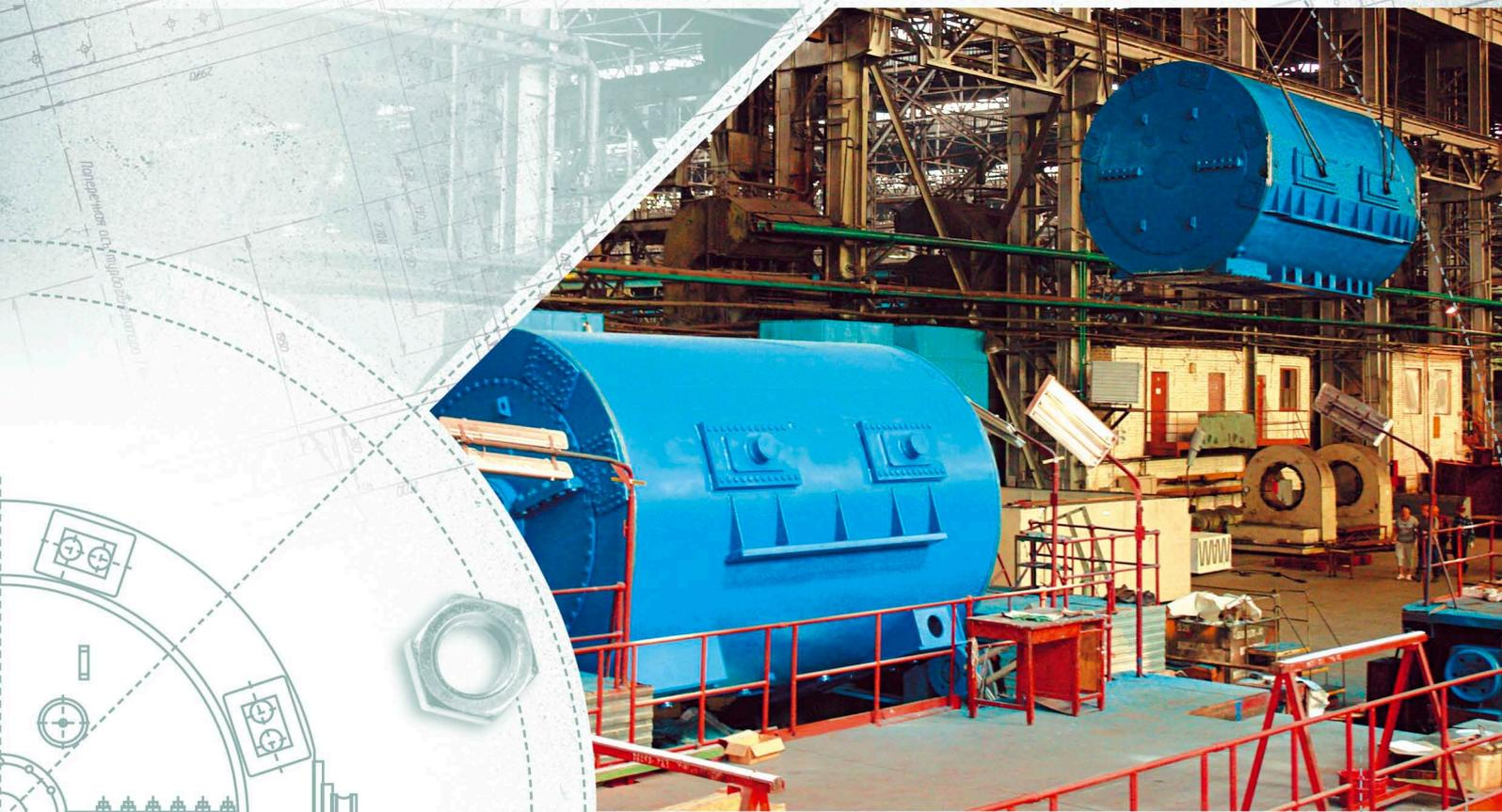
Одним из наиболее проблемных узлов турбогенератора является ротор. Высокий уровень электромагнитных, тепловых и механических нагрузок, аномальные режимы работы в сочетании с длительным сроком эксплуатации, приводят к старению изоляции обмоток роторов турбогенераторов, что требует ее замены, а в некоторых случаях и замены обмоточной меди. Кроме того необходима дефектоскопия всех участков вала ротора.
