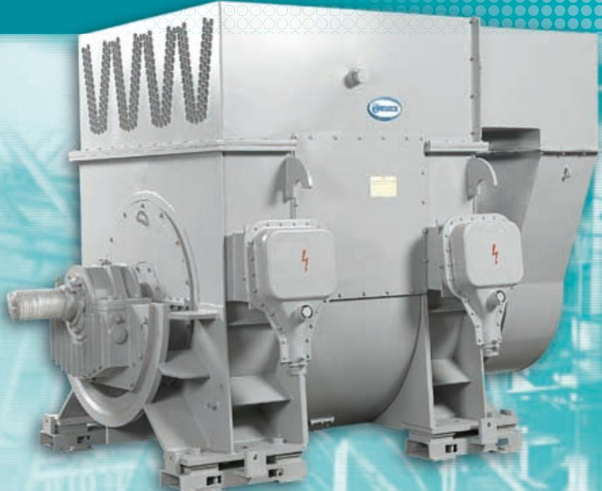
Двигатели изготавливаются с одной обмоткой на статоре и числом полюсов 6/8, 8/10, 10/12 (синхронные частоты вращения 1000/750, 750/600, 600/500 об./мин.), имеют горизонтальное исполнение на лапах с одним рабочим концом вала. Система охлаждения воздухо-воздушная. Мощность двигателя от 250 до 1600 кВт на напряжение сети 6000 В частотой 50 Гц.
