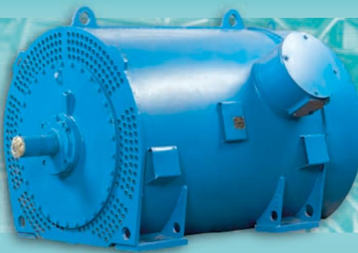
Исполнение двигателей горизонтальное на лапах с одним рабочим концом вала с видом взрывозащиты «взрывонепроницаемая оболочка» мощностью от 250 кВт до 5000 кВт на напряжение питающей сети 6000 В частотой 50 Гц и мощностью от 800 кВт до 5000 кВт на напряжение питающей сети 10000 В частотой 50 Гц.
