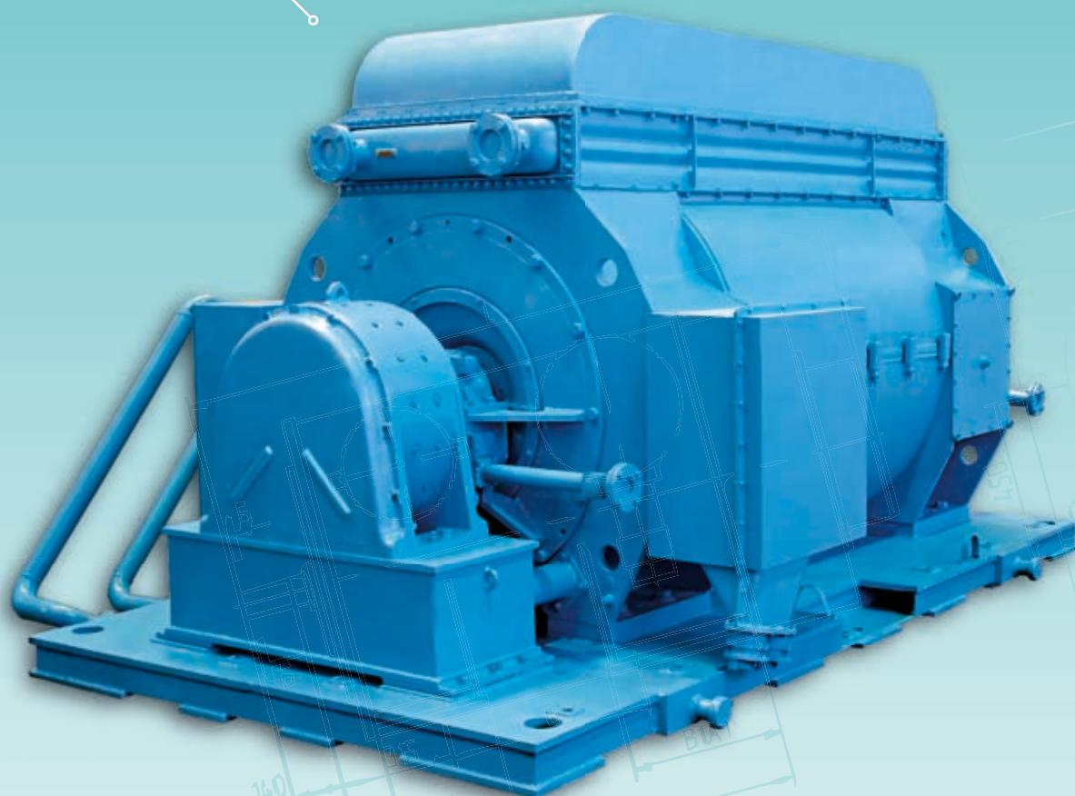
Исполнение двигателей горизонтальное на лапах с одним концом вала. Двигатели с видом взрывозащиты – «Заполнение или продувка оболочки под избыточным давлением  $p$ », с замкнутой воздухо-водяной или воздухо-жидкостной системой охлаждения, сейсмостойкого и не сейсмостойкого исполнения.
