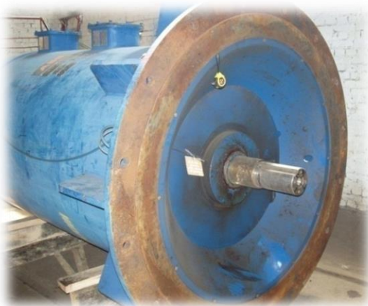
Двигатель производства АBB на ремонте
