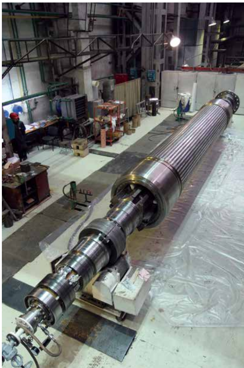
Ротор турбогенератора ТВМ-500 для Рефтинской ГРЭС в процессе ремонта
