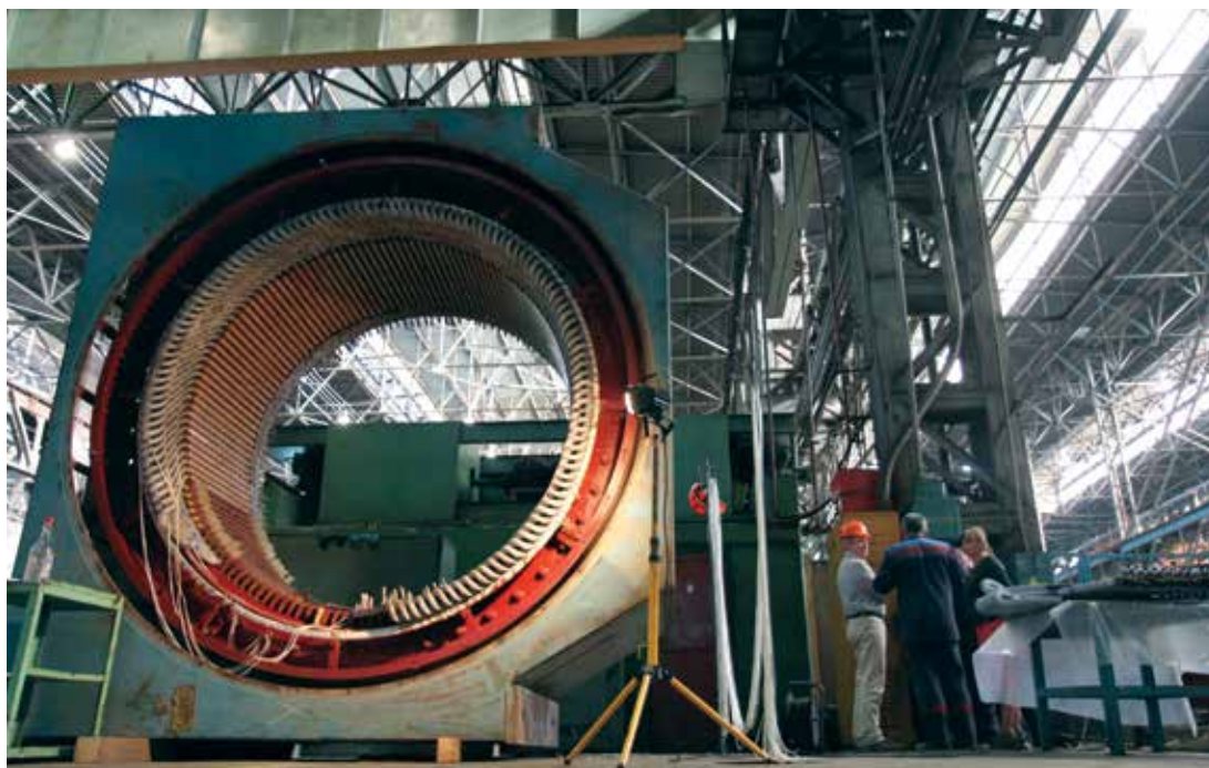
Ремонт статора двигателя АО-18-120-8/10 с заменой обмотки
