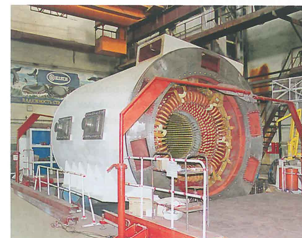
Статор турбогенератора ТФ-90Г-2УЗ в сборочном цехе НПО «ЭЛСИБ»
