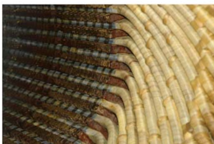
Этапы ремонта статора двигателя 4АЗМ-4000/6000УХЛ4
