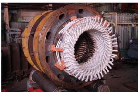
Этапы ремонта статора двигателя 4АЗМ-4000/6000УХЛ4
