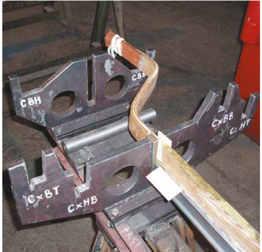
Контроль формы стержня в цехе
