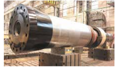
Рис. 4. Вал ротора на консервации
