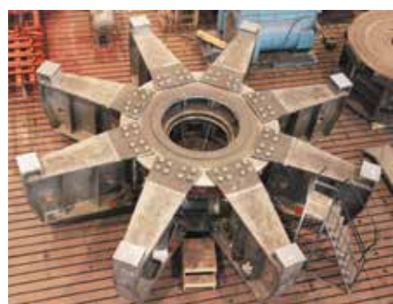
Рис. 6. Крестовина после мехобработки плоскости сопряжения с корпусом статора
