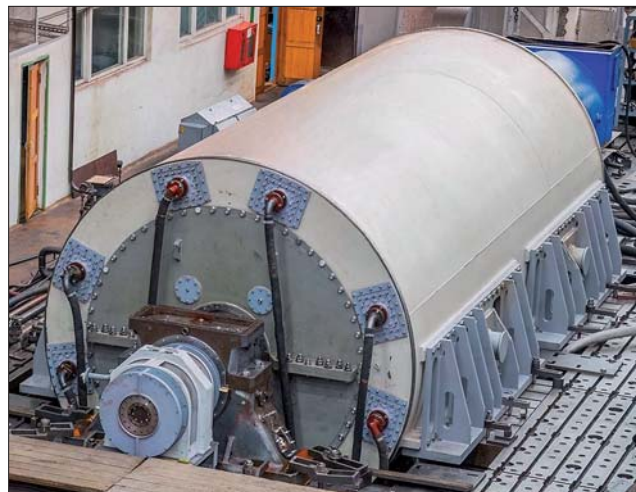
Рис. 6. Турбогенератор ТВВ-315-2У3 на испытательном стенде НПО “ЭЛСИБ” ПАО
