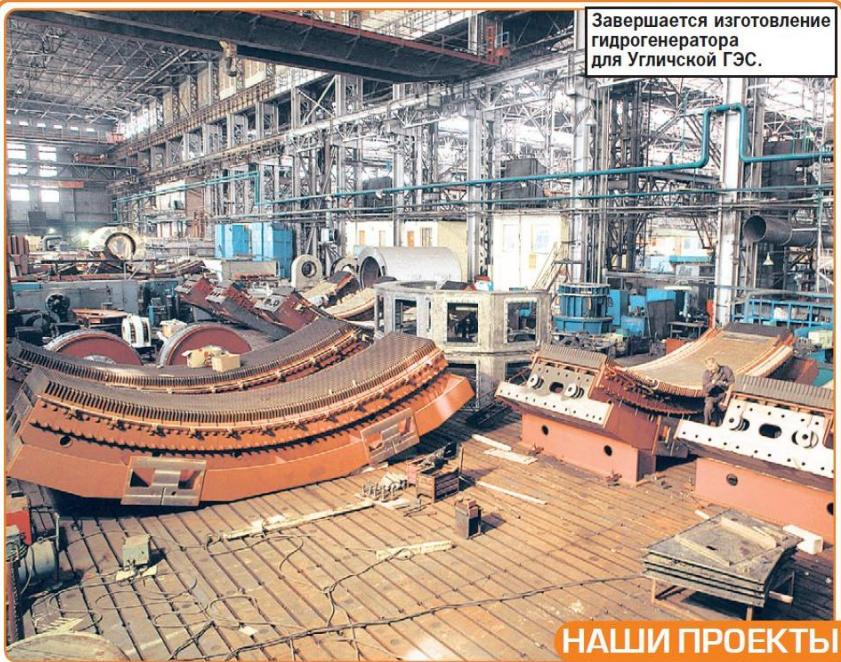
Завершается изготовление гидрогенератора для Угличской ГЭС.
