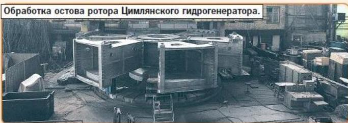
Активно идет процесс изготовления Цимлянского гидрогенератора. В августе закончена предварительная токарная обработка и расточная обработка его вала-надставки. Завершена контрольная сборка подплатника и крестовины на 11-м участке сборочного производства. К концу августа данные узлы были сданы.
