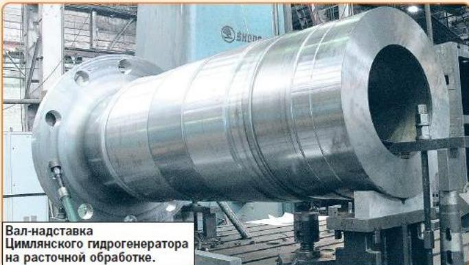
**Вал-надставка Цимлянского гидрогенератора на расточной обработке.**
