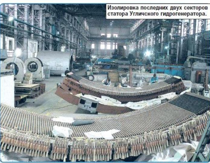
**Изолировка последних двух секторов статора Угличского гидрогенератора.**
