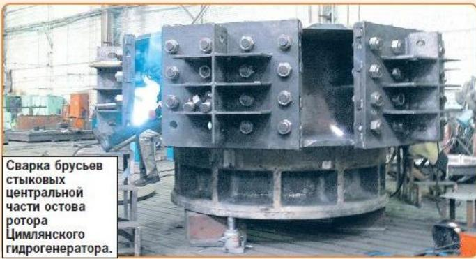
**Сварка брусьев стыковых центральной части остова ротора Цимлянского гидрогенератора.**
