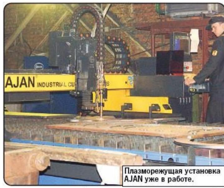
Плазморежущая установка AJAN уже в работе.
